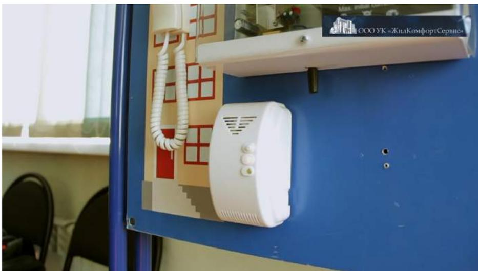
Датчик контроля утечки газа
