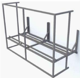
Пространственная схема корзины для кондиционера 1800(1400)x1200(h)x550
