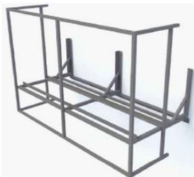
Пространственная схема корзины для кондиционера 1800(1400)x750(h)x550
