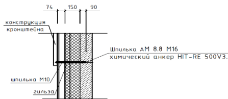
Узел крепления кронштейна кондиционера на вентилируемый фасад (несущая конструкция из железобетонных панелей)
