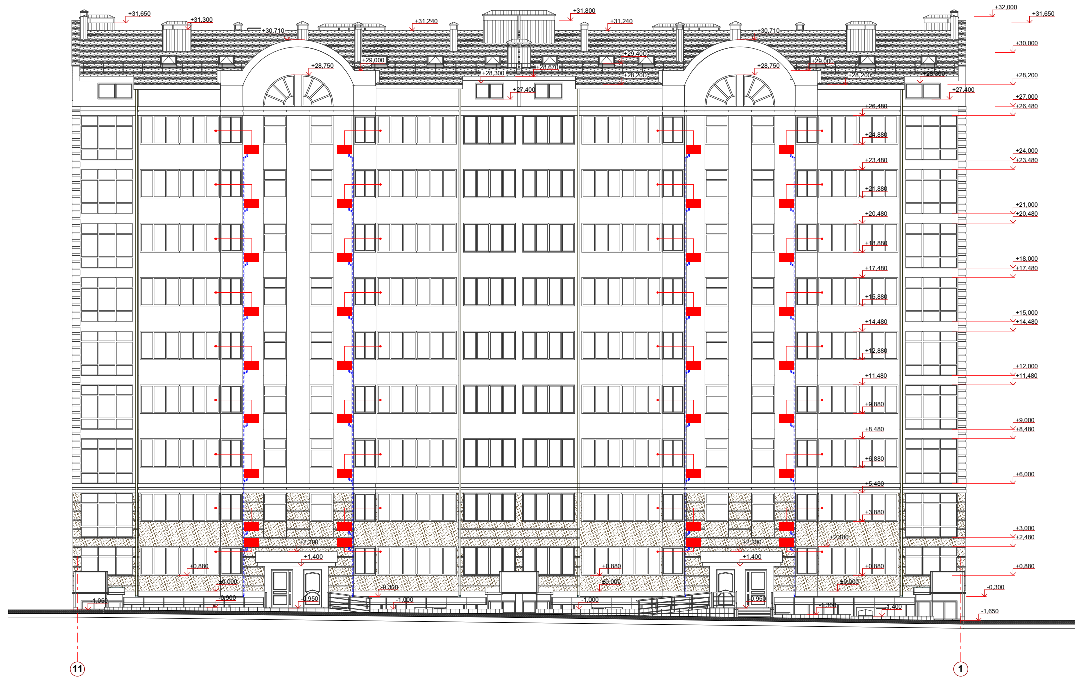
Вариант монтажа пластиковой трубы, которая крепится до утепления
