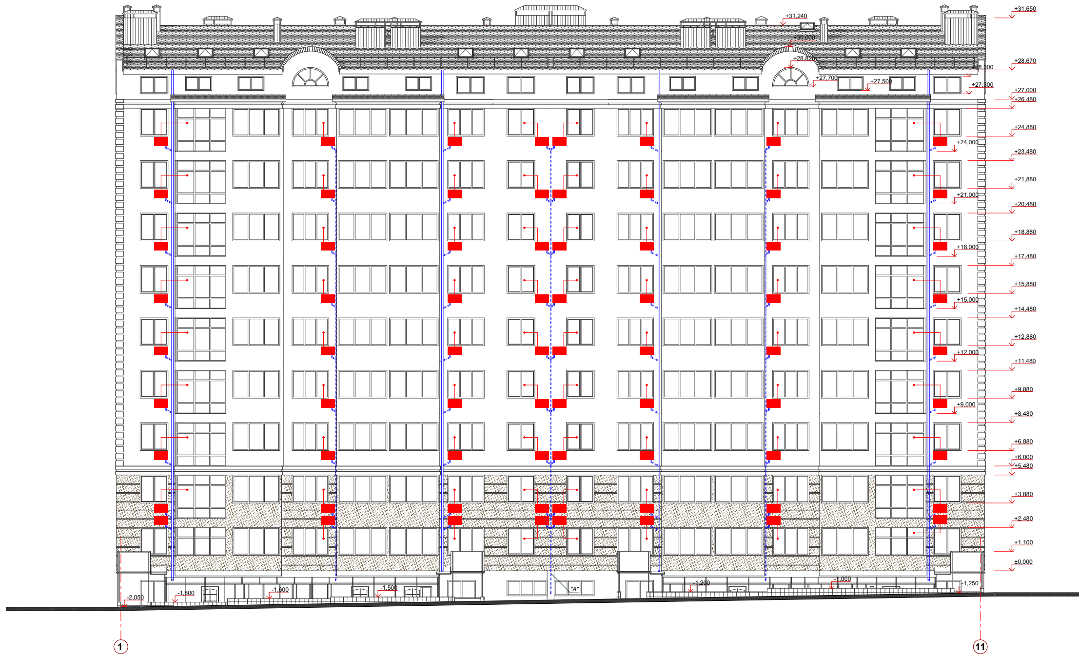
Вариант монтажа пластиковой трубы, которая крепится до утепления
