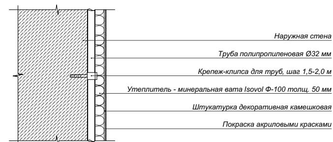
Вариант монтажа пластиковой трубы, которая крепится до утепления
